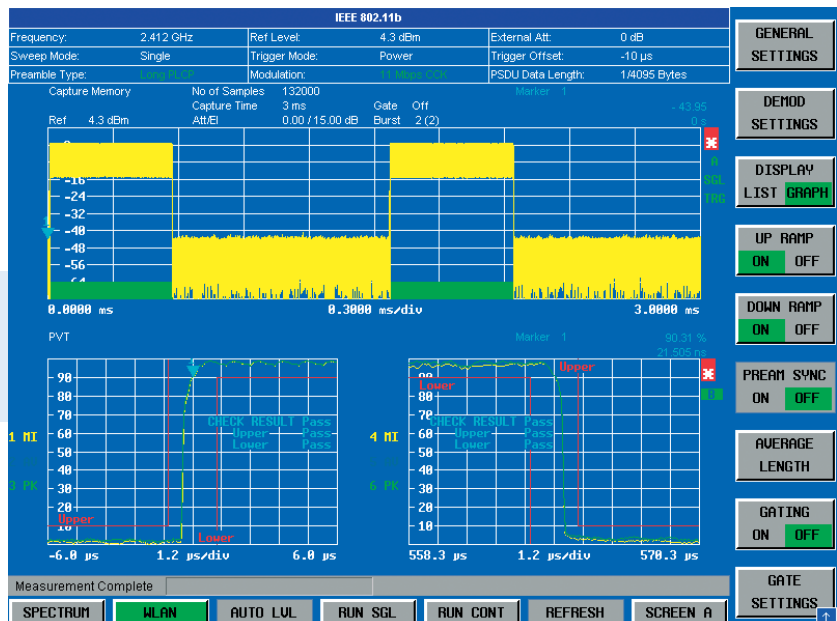
Messung der Anstiegs und Abfallzeit für ein IEEE 802.11b-Signal. Eine einstellbare Mittelung garantiert wiederholbare und stabile Messergebnisse
